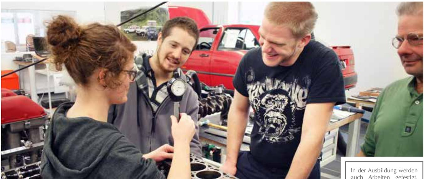
In der Ausbildung werden auch Arbeiten gefestigt, welche im Berufsalltag moderner Betriebe fehlen. Im Bild: Das Ausmessen einer Zylinderlaufbahn.
